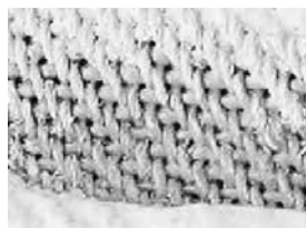
図16 綾織りの例(裏面一部拡大写真)
