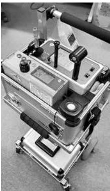
写真4 空気環境測定機器
