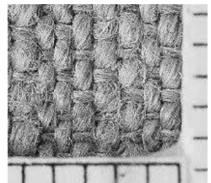
図13 平織りの例(裏面一部拡大写真)
