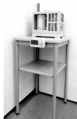
写真5 温湿度・CO 2 濃度測定ロガー設置状況
